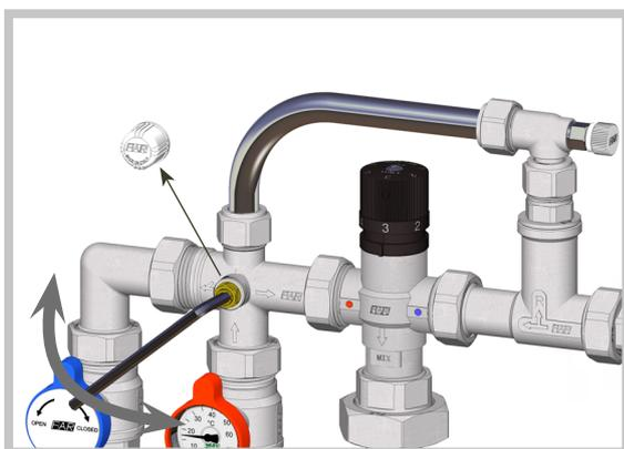
È possibile intervenire e modificare la taratura del by-pass con l'utilizzo di una chiave a brugola da 5mm. Per accedere alla vite di regolazione svitare il volantino bianco e inserire la chiave:
